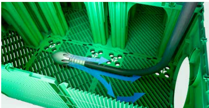
Иновативна конструкция на страничните и дънни стени - наклонено оребряване, което по време на почистването отблъсква водната струя под налягане и предотвратява повреждането на геотекстила
