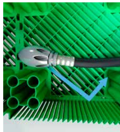
Иновативна конструкция на страничните и дънни стени - наклонено оребряване, което по време на почистването отблъсква водната струя под налягане и предотвратява повреждането на геотекстила
